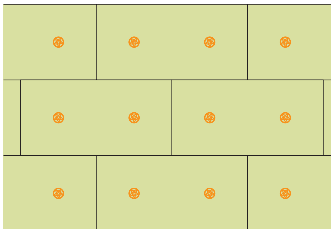
Abb. 4 : Beispielzeichnung von Anordnung der Befestigungsmittel
