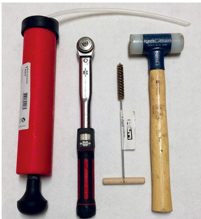
Fig. 40: Set di attrezzi con chiave dinamometrica, pistola di soffiaggio ecc. per il montaggio dei punti di fissaggio
