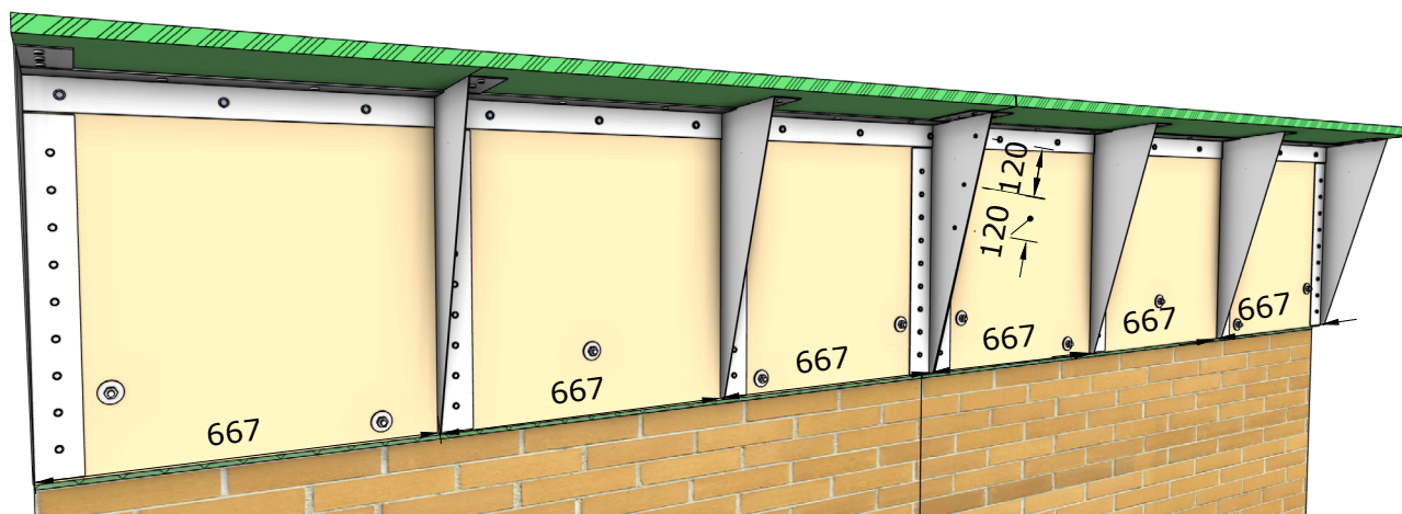
Abb. 21: Perspektivische Ansicht zwei zusammengefügter Dachrandelemente, beim Stoss ist ein Stützblech gespiegelt auszubilden und mit drei metrischen M8 Schrauben oder drei Popnieten 4,2 x 8 mm zu verbinden. Masse in mm.
