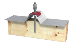
Bohrerschraube JA3-SB-8,0xL mit Dichtscheibe E16 + ORKAN-Kalotte für Trapezprofile
