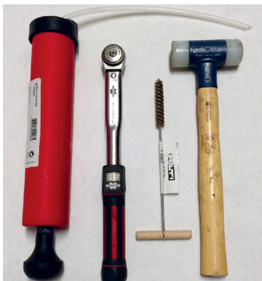
Abb. 42: Werkzeugset mit Drehmomentschlüssel, Ausblaspresse usw. für die Montage der Befestigungspunkte
