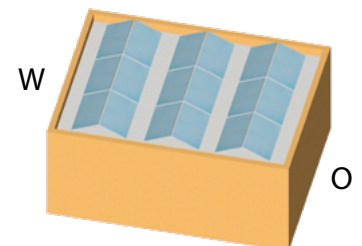
Optimale Flächenausnutzung mit Ost-West ausgerichteten PV-Modulen
