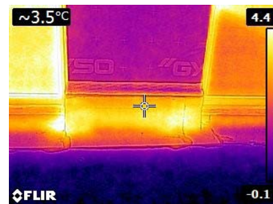
Aufnahme nach etwa 15 Minuten. Es ist klar zu sehen, dass die Oberflächentemperatur im Aufbördungsbereich bereits tiefer ist als die «Raumtemperatur des beheizten Innenraumes». Die Bauteiloberfläche im Fadenkreuz ist ca. 3,5 °C warm. Die hellgelben Stellen der Abdichtung sind gemäss Skala ca. 4,4 °C warm. Bereits nach etwa 15 Minuten kann man die Aussage machen, dass diese Aufbördung keinen Brand auslösen wird.
