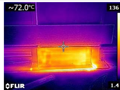
Aufnahme des Wandanschlusses unmittelbar nach dem Schweißen dieser Aufbördung. Die Bauteiloberfläche im Fadenkreuz ist ca. 72 °C warm.
