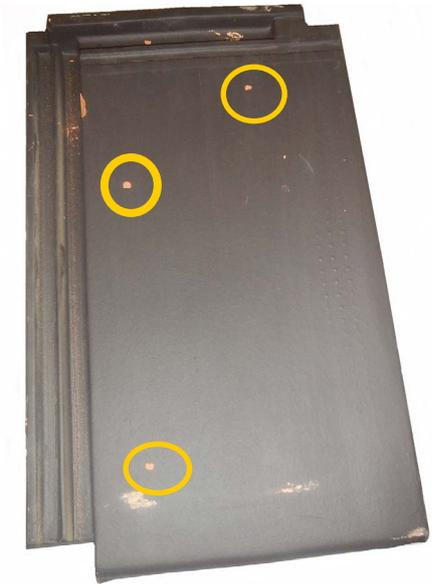
Bestimmte kornförmige oberflächennahe Einschlüsse im Dachziegel (z.B. Kalk, Pyrit) können durch feuchtebedingte Volumenvergrößerungen Teile des Ziegelscherbens, einschliesslich Engoben und Glasuren, absprenge.
