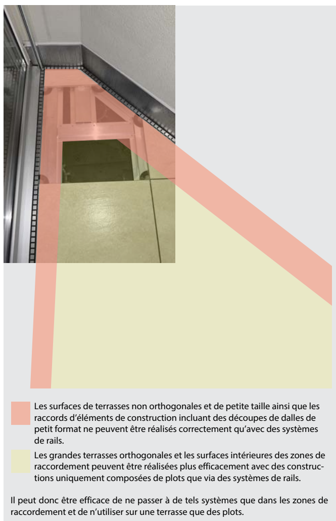
Fig. 21: Lorsque les raccords sont orthogonaux et difficiles, il faut éventuellement compléter le système de plots par des systèmes de rails.
