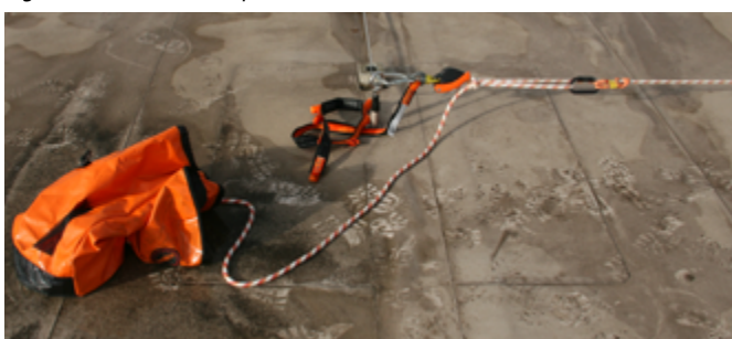
Fig. 11: Descendeur monté dans un système temporaire à corde (ligne de vie) pour la descente (rig for rescue)
