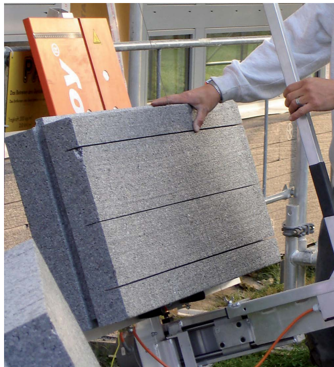
Fig. 3: tavolo di taglio per lastre di materiale espanso
