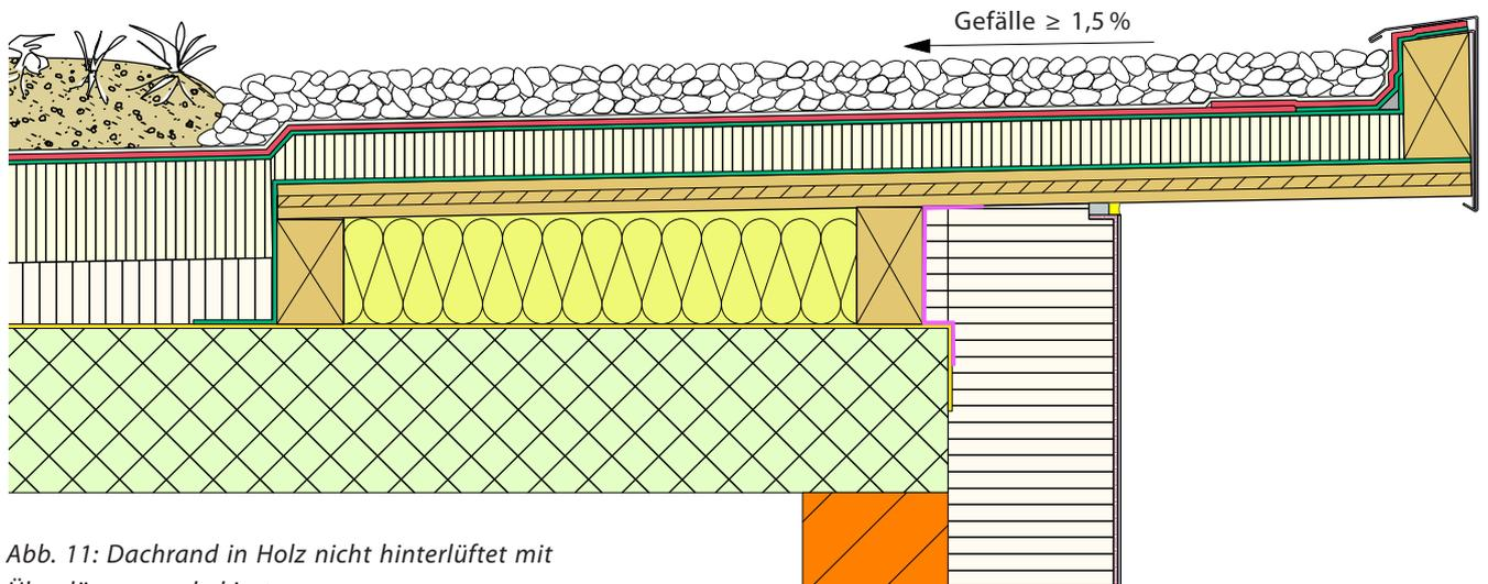
Abb. 11: Dachrand in Holz nicht hinterlüftet mit Überdämmung, bekiest
