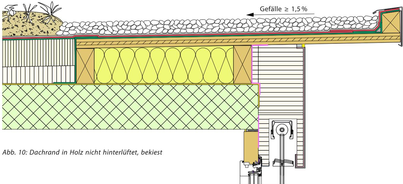
Abb. 10: Dachrand in Holz nicht hinterlüftet, bekiest
