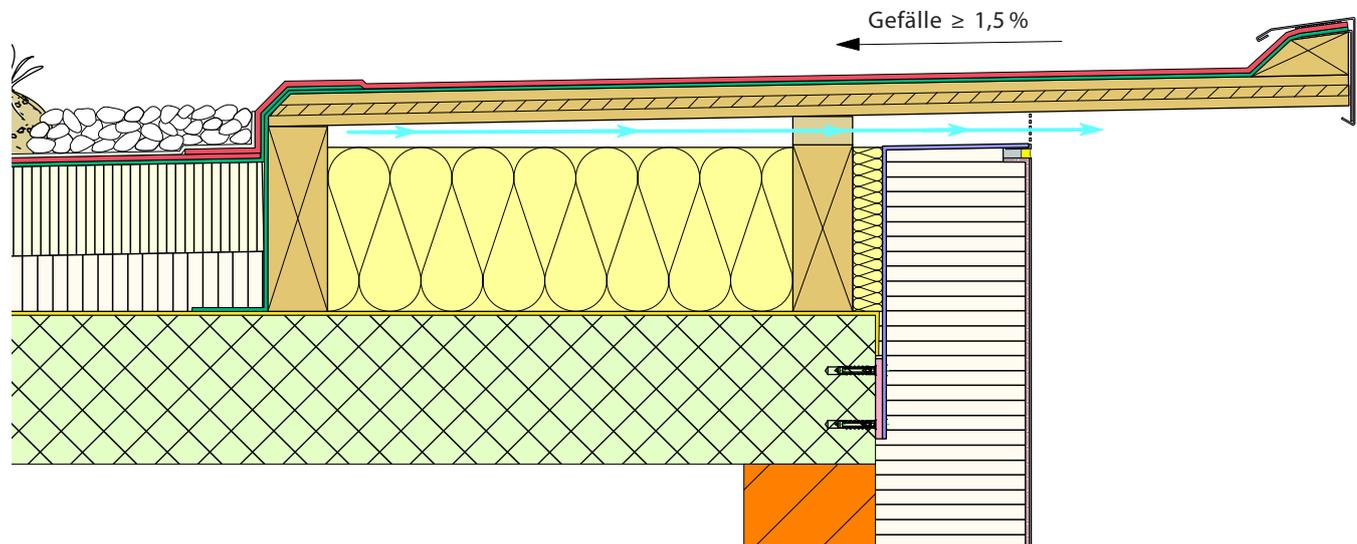
Abb. 12: Dachrand in Holz minimal belüftet als Nacktdach
