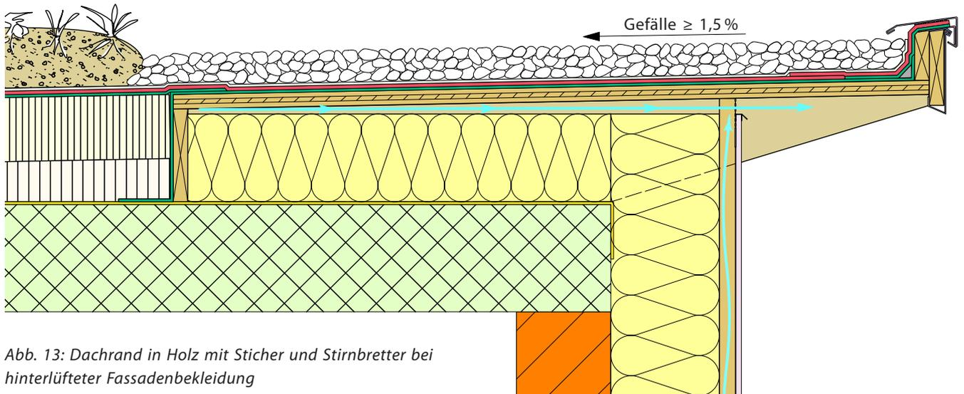
Abb. 13: Dachrand in Holz mit Sticher und Stirnbretter bei hinterlüfteter Fassadenbekleidung
