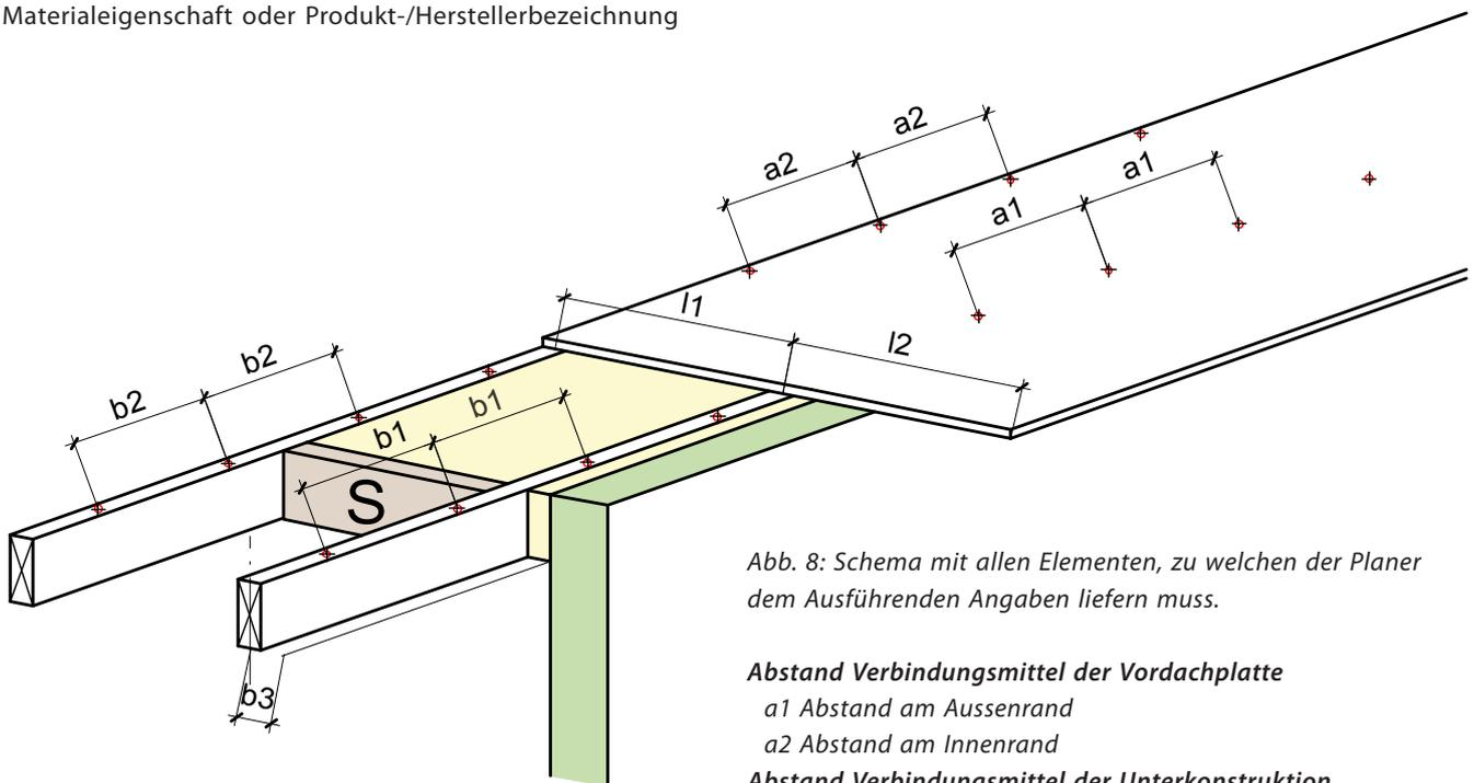
Abb. 8: Schema mit allen Elementen, zu welchen der Planer dem Ausführenden Angaben liefern muss.
