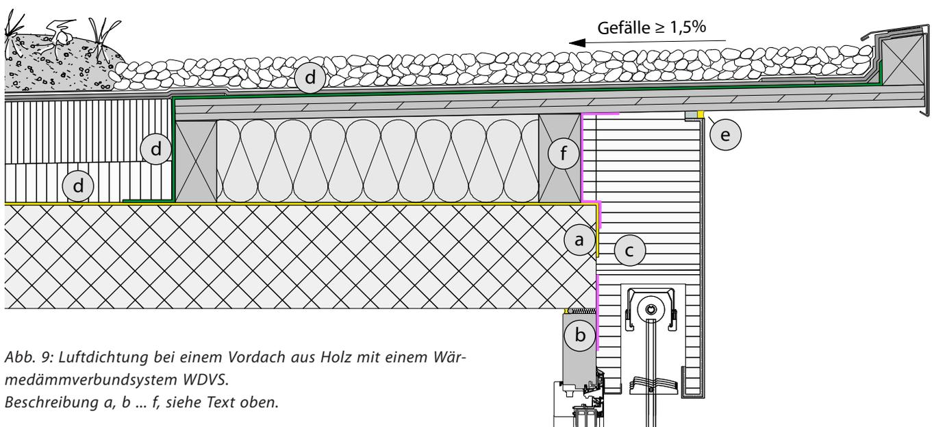
Abb. 9: Luftdichtung bei einem Vordach aus Holz mit einem Wärmedämmverbundsystem WDVS.
